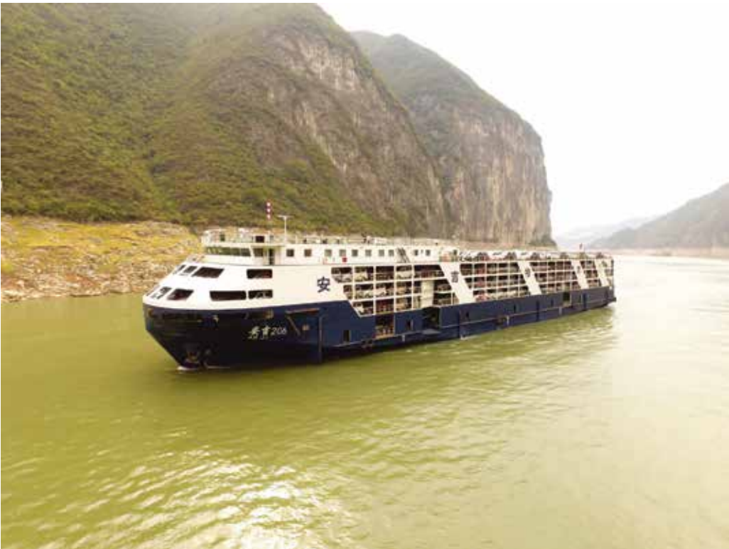
图片 3.10 适合三峡水库及船闸的新型标准化船，可载 871 辆小汽车
